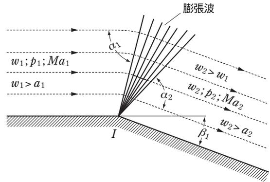
図5.9 外向きに屈曲した壁面角部に形成される膨張波
