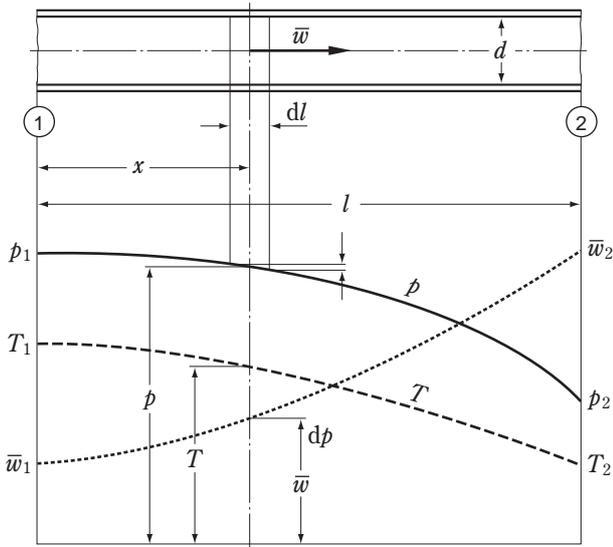
図5.12 圧縮性円管流における圧力、速度および温度変化
