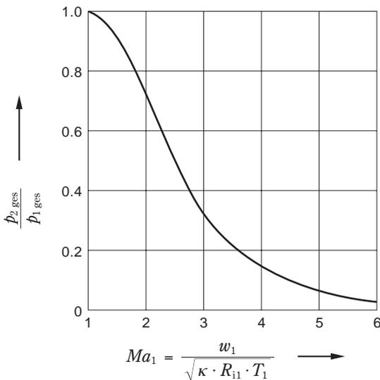
図5.6 垂直衝撃波による階段状圧縮の場合における総圧力損失
